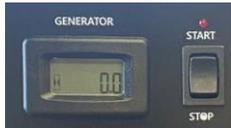
Das Wohnmobil ist mit einem integrierten Generator ausgestattet, der Ihr Fahrzeug mit 110-Volt-Strom versorgt, wenn es nicht an das Stromnetz des Campingplatzes angeschlossen ist. Außerdem werden die Batterien langsam aufgeladen. Der Generator wird aus dem Benzintank des Motors betrieben. Der Tank muss mehr als  $\frac{1}{4}$  voll sein, damit der Generator anspringt. Der Generator schaltet sich automatisch ab, sobald der Kraftstoffstand unter  $\frac{1}{4}$  sinkt.
