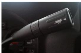
Die Tow/Haul-Funktion optimiert die Schallleistung und verringert die Gefahr einer Überhitzung oder eines Ausfalls des Getriebes durch übermäßiges Schalten beim Fahren in bergigen Gegenden. Diese Funktion bietet zusätzliche Leistung beim Bergauffahren und Bremsunterstützung durch den Motor beim Bergabfahren, um das Risiko einer Überhitzung der Fahrzeugbremsen zu verringern. Wählen Sie diese Funktion durch Drücken der Taste im Schalthebel auf der rechten Seite des Lenkrads.
