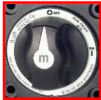
Der Hauptschalter zum Ein- und Ausschalten der Hausbatterien befindet sich direkt neben der Seiteneingangstür auf Bodenhöhe. Er muss auf EIN (ON) stehen, damit die Geräte und der Wohnbereich mit 12-Volt-Strom versorgt werden. Wenn kein Strom vorhanden ist, prüfen Sie, ob dieser Schalter versehentlich auf AUS (OFF) gestellt wurde, und stellen Sie ihn auf ON.
