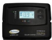
Das Wohnmobil ist mit einer Solaranlage auf dem Dach ausgestattet, die die Hausbatterien auflädt, wenn sie dem Sonnenlicht ausgesetzt ist. Das Solarsystem ist automatisiert und muss nicht manuell bedient werden. Bitte nehmen Sie keine Änderungen an den Standardeinstellungen auf dem Bedienfeld vor.
